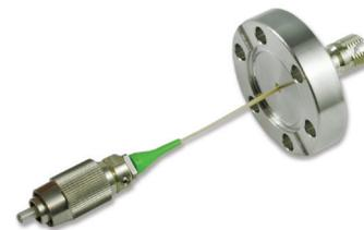
V-FT sur bride CF DN16 du côté vide avec rainure pour joint en cuivre et pigtail FC de sortie.
